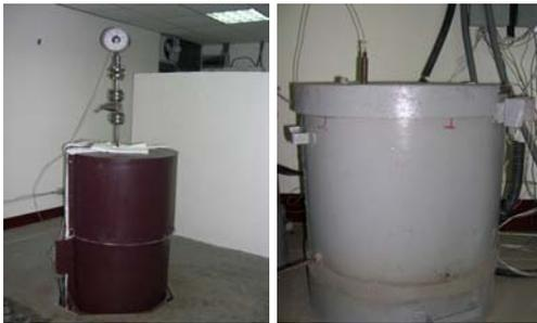
圖一 24L長晶爐 圖二 0.5L長晶爐
