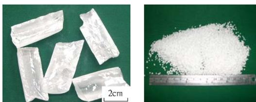
圖二 氧化鋁原料(a)塊材，(b)粉料
