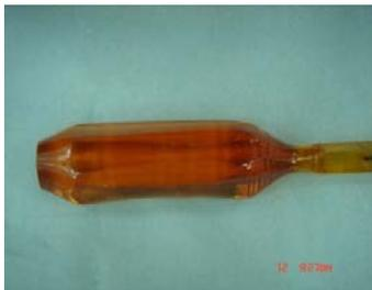
LGS是一種新的壓電材料，國內尚無廠商生產製造，儘管其單晶體及SAW晶圓是可以用的，且特性優於石英、 $\text{LiNbO}_3$ 或其他晶體。雖有以下幾項缺點限制了業界導入的困難，1.複雜的化學結構長晶困難，2.鎵(Ga)的需求量大且相當昂貴，3.因結構紊亂影響了材料特性的一致。所以本校與致力研發LGS晶體有成的俄羅斯合作，成立長晶中心，利用俄羅斯成熟的技術，在本中心加以分析研究，以期降低上述的困難，達到業界在壓電材料上的要求，並希望能藉此提高台灣在世界上的競爭力。
