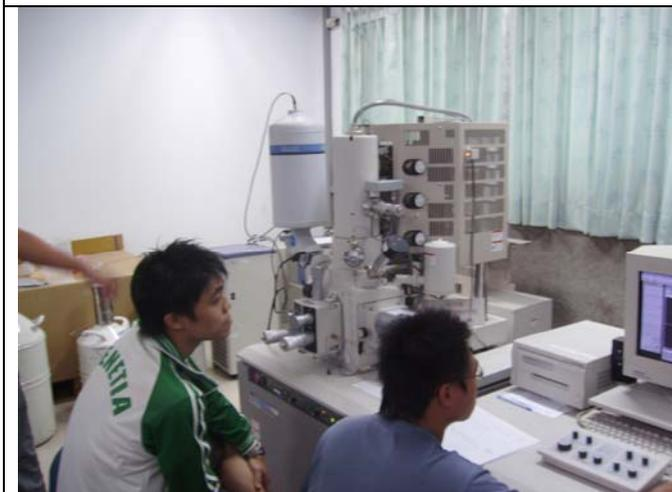
介紹台科大材料及資源工程系掃描式電子顯微鏡實際操作情形
