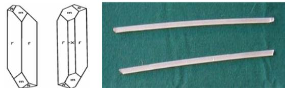
圖4 棒狀晶種(5 x 5 x 350 mm)
