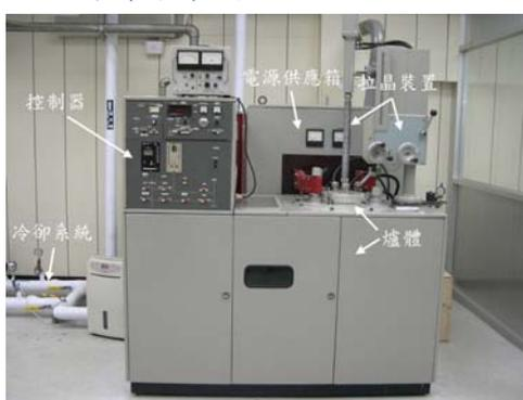
圖一 藍寶石長晶爐照片
