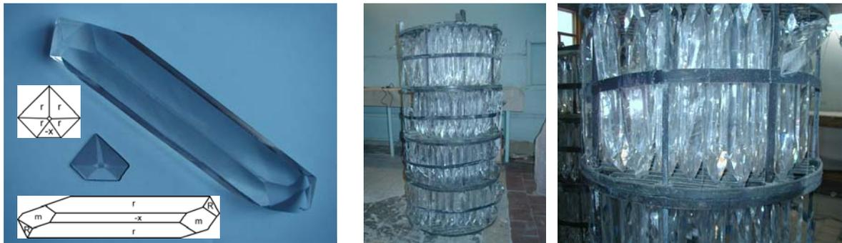
圖1 低差排r-bar 石英與AT-cut 圖2 低差排r-bar 石英量產情形(1500公升長晶爐)
