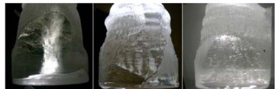
圖四 不同降電壓速率(降溫)所得藍寶石晶碗之巨觀缺陷觀察，(a) 30 mV/hr(b)25 mV/hr(c)20 mV/hr
