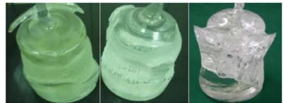
圖三 三種降電壓速率(降溫)所得藍寶石晶碗之外觀顏色比較，(a)30mV/hr、(b)25 mV/hr、(c)20 mV/hr
