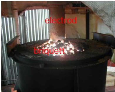
圖3 Batch式電弧爐反應情形
