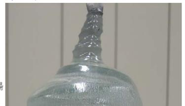
圖十一. 微調時所形成的晶頸形狀
