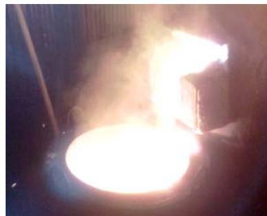
圖4 反應後之多晶矽熔湯
